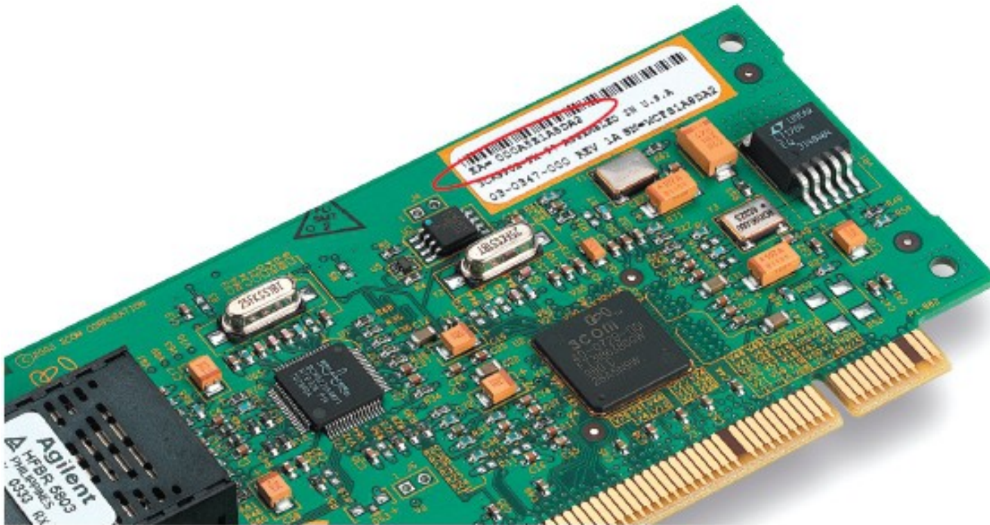
شکل ۲-۶ آدرس MAC یک کارت شبکه
